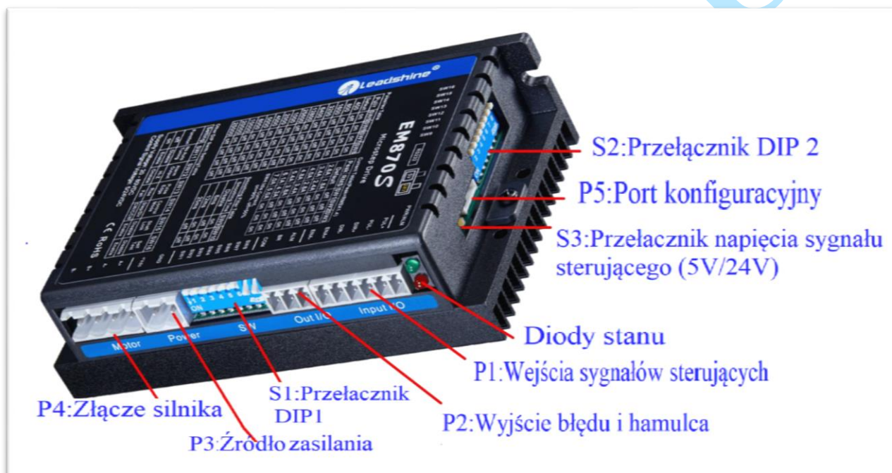
Rys. 2. Złącza, przełączniki DIP i diody LED
